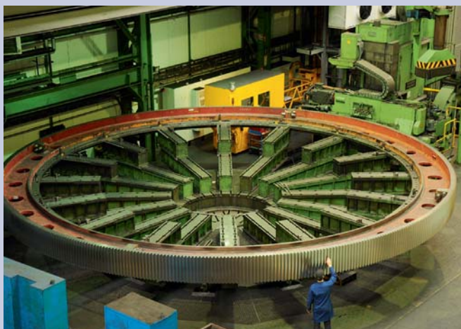
Couronne de 13 mètres de diamètre pour la mine d'or en Russie.
