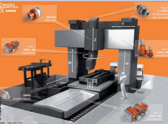
Intégration de composants REDEX dans une machine portique à commande numérique DMG.
